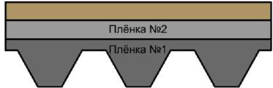
Рис. 18. Тыльная сторона гонта гибкой черепицы Döcke PIE.
